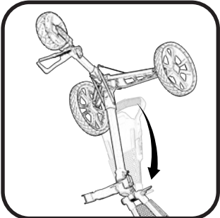
Relâcher le verrou de la poignée et ajustez la poignée à la hauteur qui vous convient.
